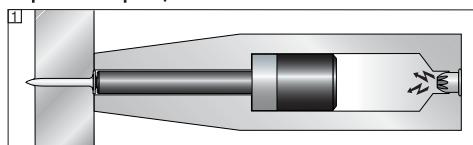
Энергия порохового заряда передается на поршень, ускоренная масса которого забивает крепежный элемент в базовый материал. При приеме поршнем приблизительно 95 % кинетической энергии крепежный элемент забивается в базовый материал с контролируемой мощностью и со значительно уменьшенной скоростью (менее 100 м/сек). Процесс забивки завершается, когда поршень доходит до конца пути пробега. При правильном использовании инструмента это делает сквозные пропилы теоретически невозможными.
